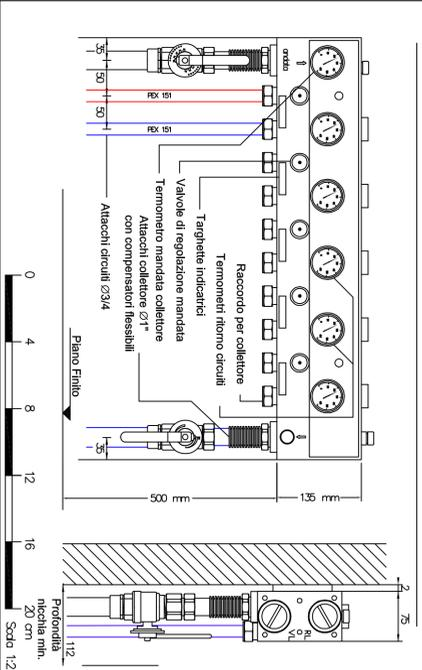
SEZIONE PAVIMENTO RADIANTE
